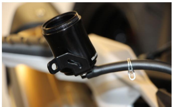
Die beiliegende Sicherungsklammer auf den originalen Schlauch schieben.
