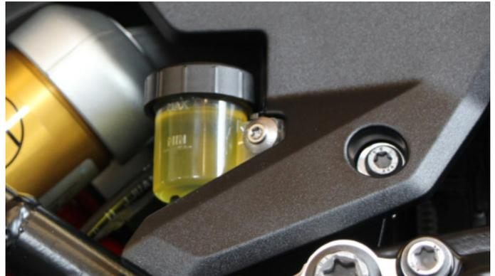
Den beiliegenden Halter mit den O-Ringen, Schrauben und Unterlegscheiben an den AC Schnitzer Bremsflüssigkeitsbehälter anschrauben. (siehe Bild).
