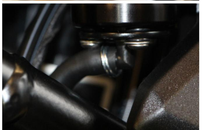
Ggf. die Klammer etwas zusammendrücken um mehr Vorspannung zu erreichen.
