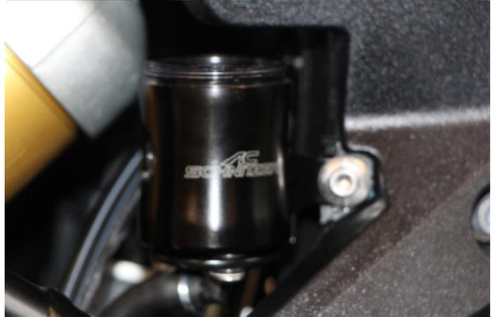
Durch mehrmaliges zusammendrücken des Schlauches sicherstellen, dass keine Luftblasen im Schlauch sind.
