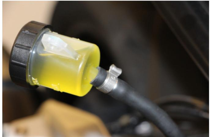
Mit einer Flachzange oder einem Schraubendreher die Sicherungsklammer am Behälter lösen und den Vorratsbehälter vom Schlauch so abziehen, dass weder aus dem Schlauch noch aus dem Behälter Flüssigkeit austreten kann.
